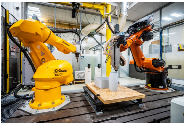
Robotické pracoviště velkorozměrového 3D tisku z plastů v Testbedu Průmyslu 4.0 – sdílené pracoviště FS a CIIRC ČVUT (zdroj: Jiří Ryszawy)
