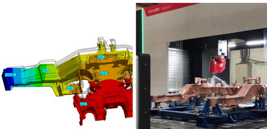
Optimalizace upnutí dílce provedená na základě analýzy deformací dílce metodou konečných prvků. Výroba podvozku lokomotivy probíhala na stroji FRUN. (zdroj: RCMT a TOS Kuřim – OS)
