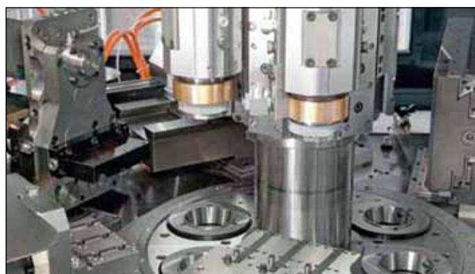
Pohled do pracovního prostoru šestivřetenového soustružnického automatu
