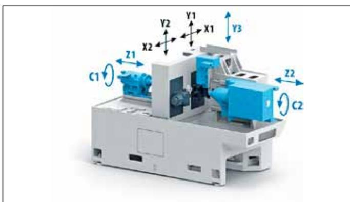
Schéma řízených pohybových os stroje K'MX 723 EVO
